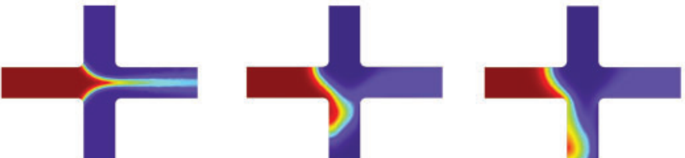
Abb. 4: Die Konzentrationsverteilung während des Fokussierungs- (links) und des Injektionsstadiums (Mitte, rechts) in einem elektrokinetischen Ventil. Die Trennung ist infolge der Erdung der Enden des linken und rechten Kanals unzureichend. Das Modell wurde angeregt durch Ermakov et al [3] und in Femlab mit den Anwendungsmoden Incompressible Navier-Stokes, Conductive Media DC und Elektrokinetische Strömung berechnet.
