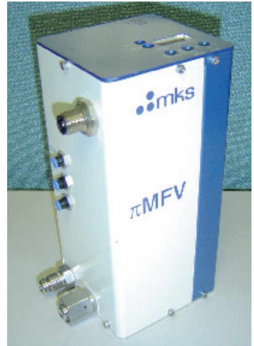
Im Mengenflussregelgerät pi-MFC führt ein integrierter Prozessor in Echtzeit vereinfachte Navier-Stokes-Gleichungen aus.
