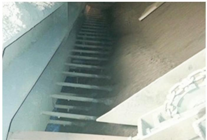
ABBILDUNG 5. Die Zuführung der Sinteranlage erfolgt mit zwei Reihen von horizontalen Permeabilitätsstäben..
