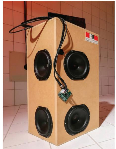
**ABBILDUNG 1.** Aktiver elektroakustischer Resonator-Prototyp. Bildnachweis: EPFL/Alain Herzog.
