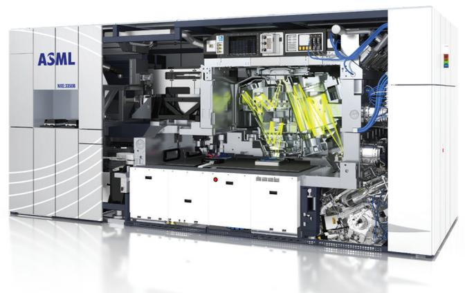
**ABBILDUNG 2.** Das serienreife EUV-System ASML® TWINSCAN® NXE:3350B produziert 125 Computerwafer pro Stunde bei 13,5 nm Wellenlänge. Es muss ein perfektes Vakuum halten, während Wafer mit hohen Geschwindigkeiten und Lasten bewegt werden, wobei Verzerrungen von weniger als 1 nm eingehalten werden müssen.
