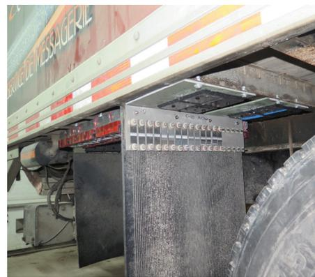
**ABBILDUNG 2.** Oben: Galvanische Korrosionsschäden an einer Multimaterial-Überlappung aus einem kohlefaserverstärkten Polymer (CFK) und einer Aluminiumlegierung der 6000er Reihe nach einem Jahr Einsatz im Fahrzeug. Unten: Typische Montage von Proben an einem Fahrzeug für die Expositionsprüfung im Betrieb.
