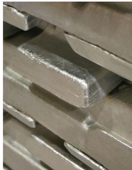
**ABBILDUNG 1.** Eine Aluminium-Druckgusslegierung (High-Pressure Die Casting, HPDC).
